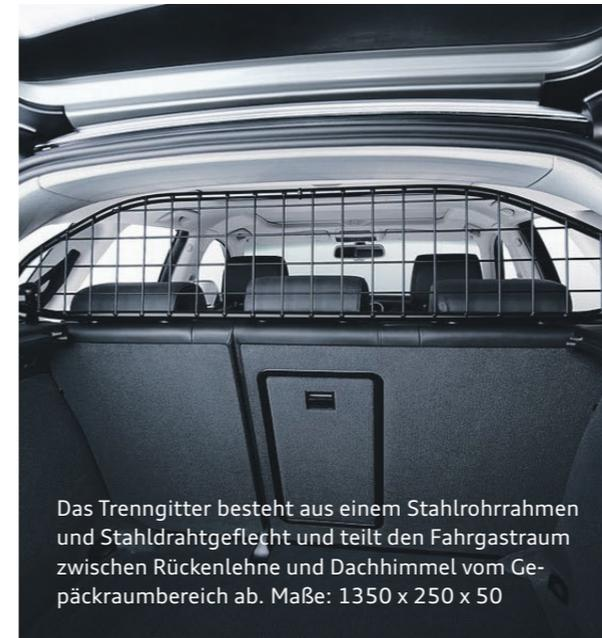
Das Trenngitter besteht aus einem Stahlrohrrahmen und Stahldrahtgeflecht und teilt den Fahrgastraum zwischen Rückenlehne und Dachhimmel vom Gepäckraumbereich ab. Maße: 1350 x 250 x 50
